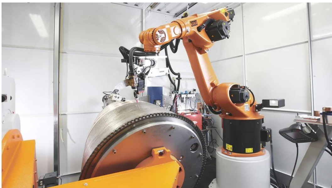
5 - сурет - KUKA роботталған қолмен жабдықталған 3D принтер
